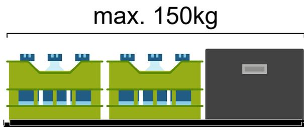
Belade deine heckBOXX flächig maximal mit 150kg.
